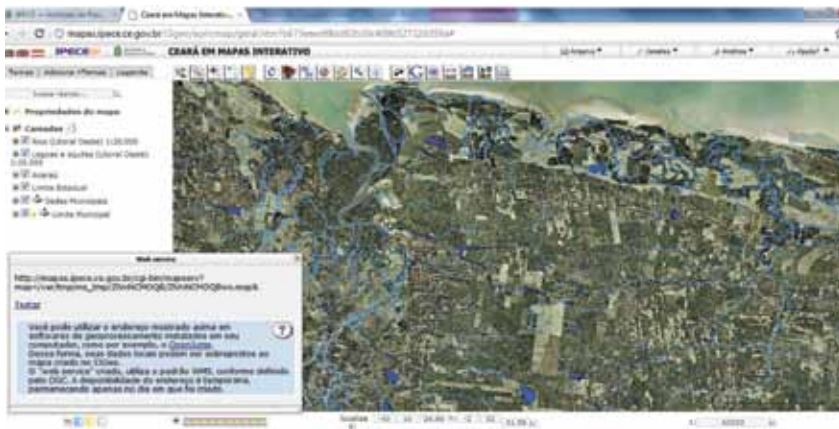
Figura 14 - Exemplo de conexão WMS realizada, gerando-se uma URL para acesso das informações via SIG's Desktop.
